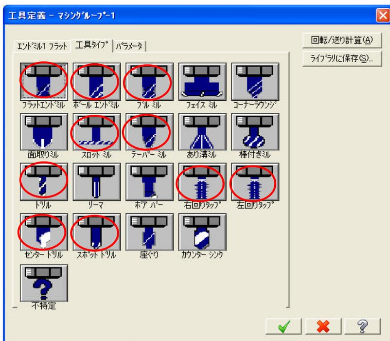
先端径とシャンク径が異なる場合は、NC View 上ではシャンク径は先端径と同じ太さで表示されます。先端径と異なるシャンク径で表示されたい場合は、シャンクより上の部分を NC View の設定でホルダとして設定する必要があります。
