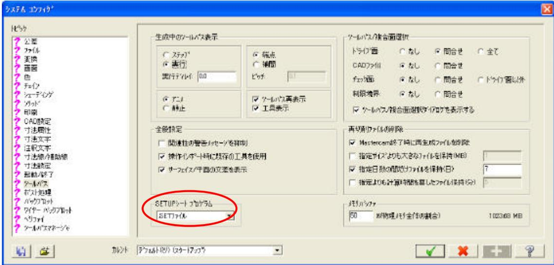
5 . Mastercam の制御機定義を開き、ファイル Mill で使用ファイルの SETUP シートテンプレートを ncview.set に変更します。
